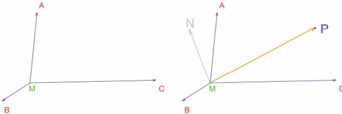
**Abb. 3.1** - [Links]. Ausgehend von drei beliebigen Punkten A, B und C sowie einem Punkt M werden die Vektoren  $\overrightarrow{MA}$ ,  $\overrightarrow{MB}$  und  $\overrightarrow{MC}$  konstruiert.
