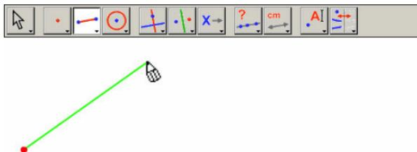
**Abb. 1.2** – Konstruktion des ersten Punktes. Bis zur Wahl des zweiten Punktes bewegt sich eine Vorschau der endgültigen Strecke mit dem Cursor mit.
